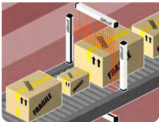
Двумерное сканирование объекта при перемещении по конвейеру с использованием двух световых завес. Если необходимо измерить объем объекта, можно задействовать третье устройство в горизонтальной плоскости или учесть скорость конвейера.
