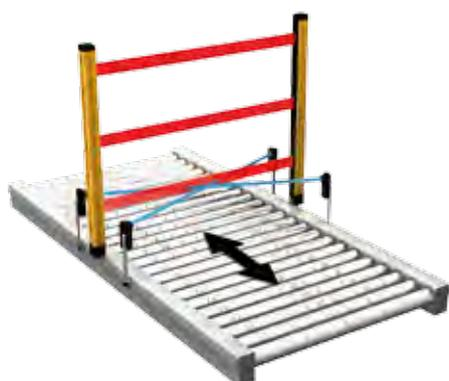
Двустороннее приглушение с 2-мя датчиками. Вход/выход поддонов.
