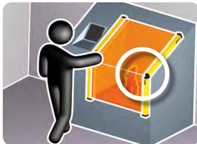
Разрешение (до 40 мм) поддерживается на стыке двух зон защиты.
