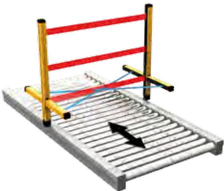
**Двустороннее приглушение с 2-мя датчиками - вход/выход.**
