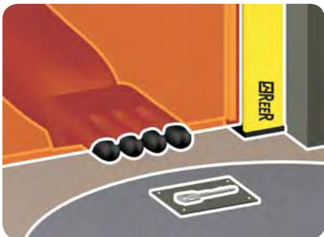
Зона защиты расширена до края световой завесы с сохранением разрешения 40 мм.
