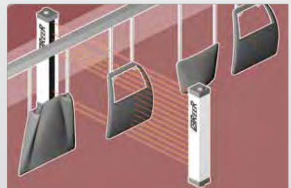
Определение положения и профиля деталей в покрасочных линиях
