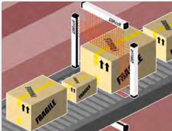
Двумерное сканирование при перемещении объекта по конвейеру с использов. двух световых завес. Если необходимо измерить объем объекта, можно задействовать третье устройство в горизонтальной плоскости или учесть скорость конвейера.
